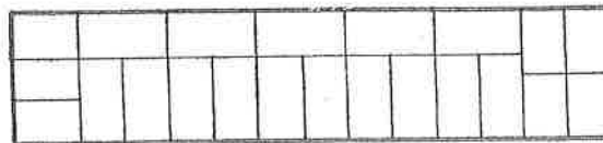
6. ЗАВРШАВАЊЕ ЗИДА ИЗМЕЂУ ОТВОРА ДУЖИНА ДЕЉИВА СА \frac{1}{4} ОПЕКЕ
