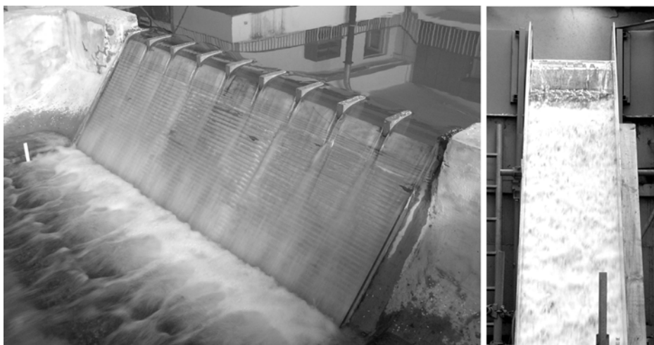
Слика 3.94: Хидраулички модели прелива са степенастим брзотоком бране „Боговина”, на реци Црни Тимок: а) модел целине у размери 1:45 и б) парцијални модел у размери 1:12.
