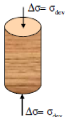
Povećanje aksijalnog napreznja uz zadržavanje bočnog tlaka stalnim (devijatorsko napreznje)
