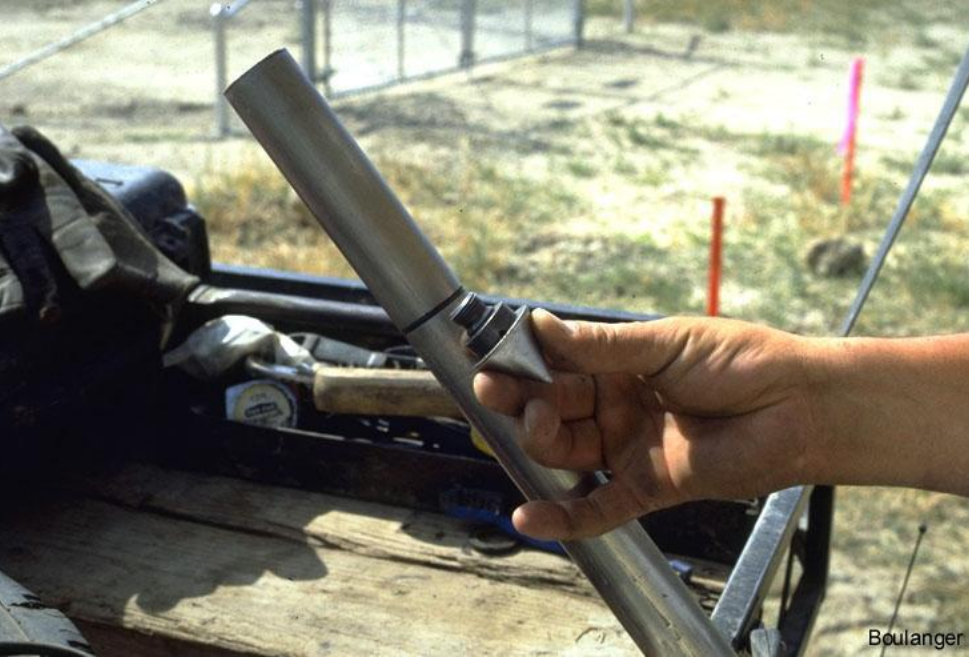
Sonda i šiljak za CPT
