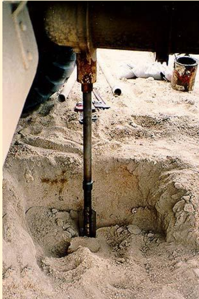
Terenska krilna sonda in-situ
